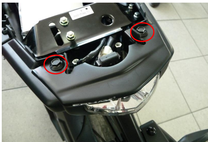
Vis de la coque arrière à démonter
