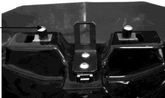
Avant d'effectuez le serrage définitif, présentez le capot de selle sur la moto, centrez-le (jouez sur la position des agrafes si nécessaire), démontez-le et serrez les vis de manière à bloquer le positionnement de la patte et des centreurs.
