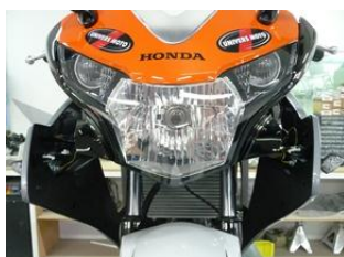
Flancs de carénage déclipés.
