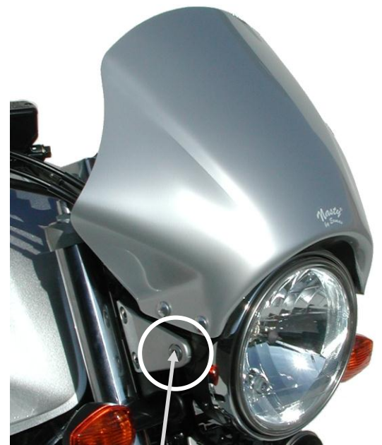
Vis de fixation du saute-vent
