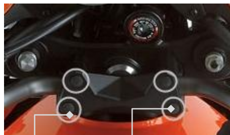
Photo 2 Vis à démonter et à remplacer
